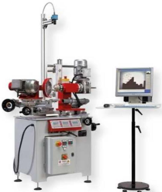
Le Grinder Diamut est une machine pour la rectification des profils de toutes les meules diamant utiliser dans le façonnage du verre et de la pierre. La machine est dotée de deux moteurs électrique : un pour faire tourner la meule qui est tenu par un cône ISO 40 et l'autre moteur qui fait tourner la meule de rectification pour reprofilier la meule diamant.
